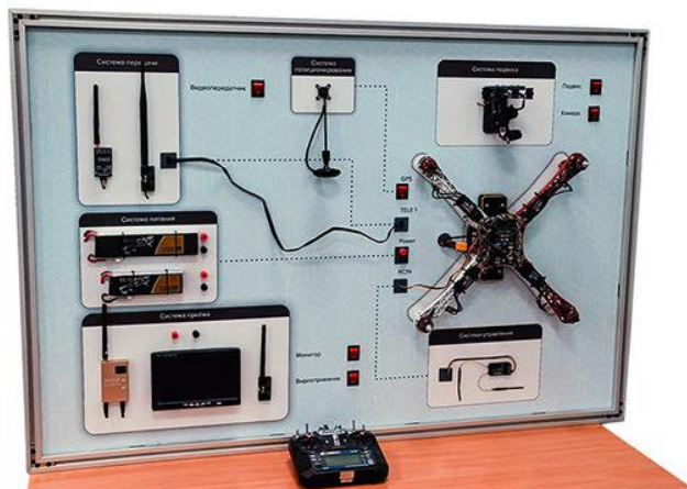
Рис. 1. Вариант стенда по изучению БАС (ФАК-ЭАОМТ0-01 ProgramLab). Fig. 1. Option of a stand for studying BAS (ФАК-ЭАОМТ0-01 ProgramLab).
