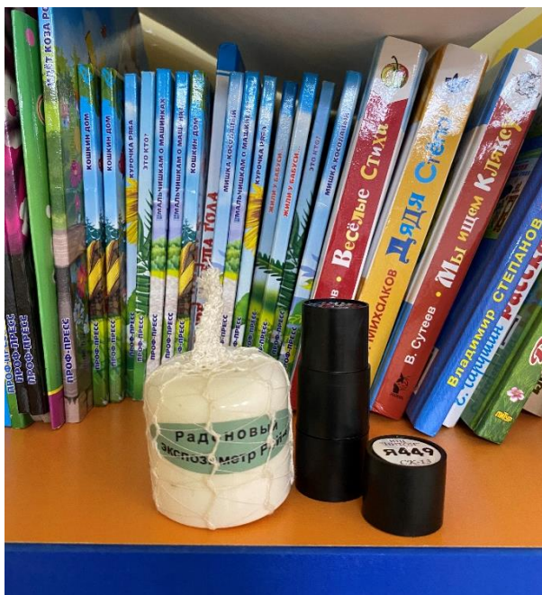
Рисунок 2.2 – Проведение интегральных (слева) и квазиинтегральных (справа) измерений ОА радона в воздухе помещений 12С
