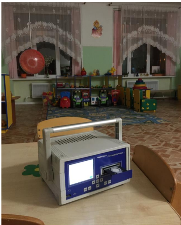
Рисунок 2.3 – Проведение экспрессных измерений ЭРОА изотопов радона в воздухе помещений 5С после 12-часовой ночной выдержки помещений с закрытыми дверьми и окнами согласно п. 6.5 МУ 2.6.1.2838-11
