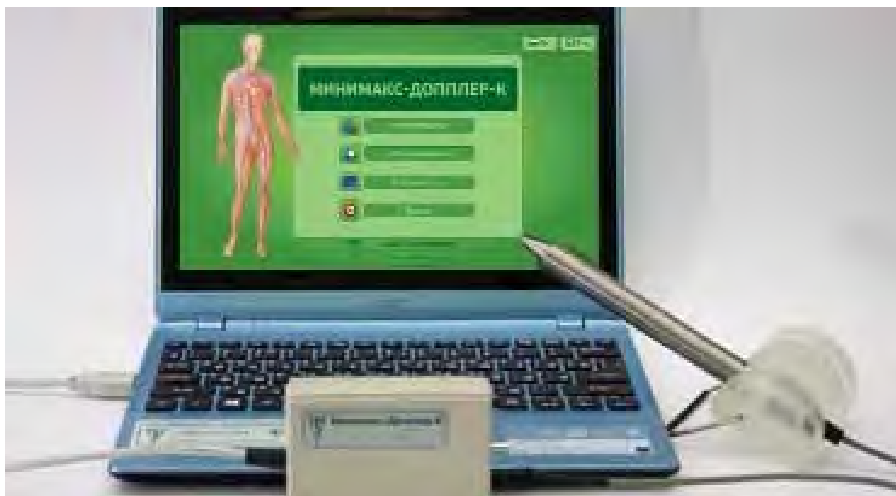
Рисунок 2 - Прибор «Минимакс–Допплер К» и датчик с частотой 25 МГц
