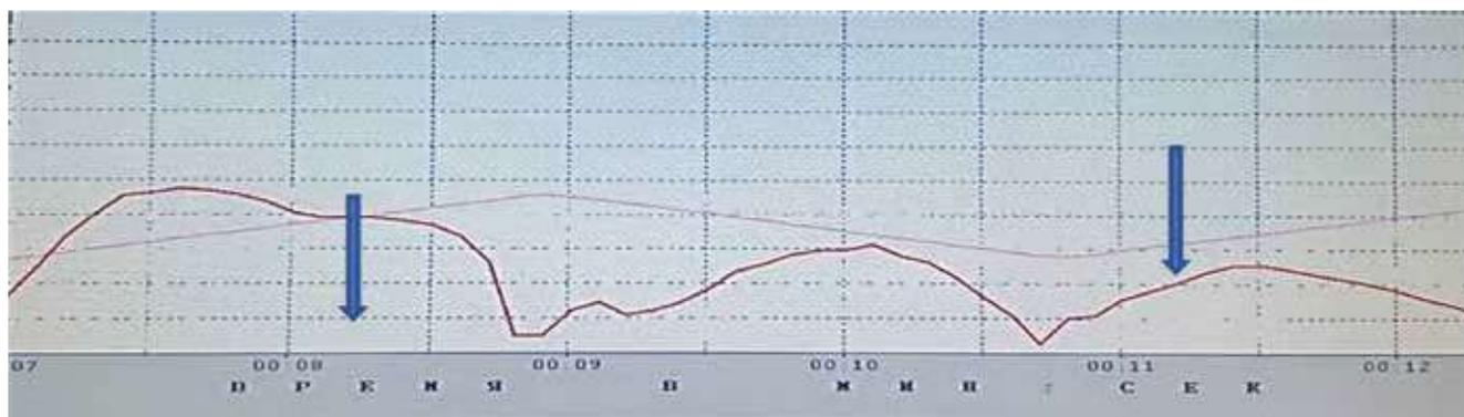
**Рисунок 1. График кривой вращающего момента в диапазоне движения**
