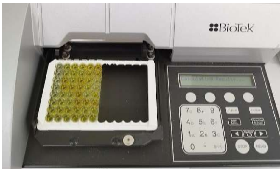
Рисунок 2.2 – Процесс измерения оптической плотности с помощью автоматического фотометра
