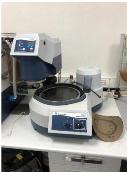
Рисунок 5 – Автоматический шлифовально-полировальный станок Beta Grinder-Polishes, Vector Power Head, Pri Met 3000 Modular dispensing system (Buehler, Германия)
