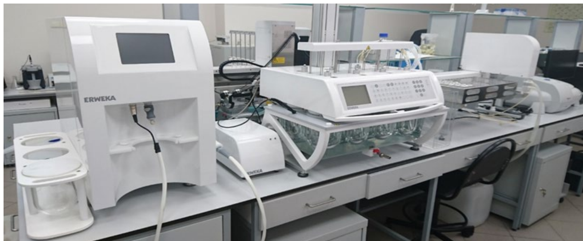
Тестер растворимости ЛВ из пероральных ЛФ Erweka (Германия): – DT828 (USP 1, 2, 5, 6) с коллектором фракций FRL и MediPrep 822 – BioDis RRT10 (USP 3,7)
