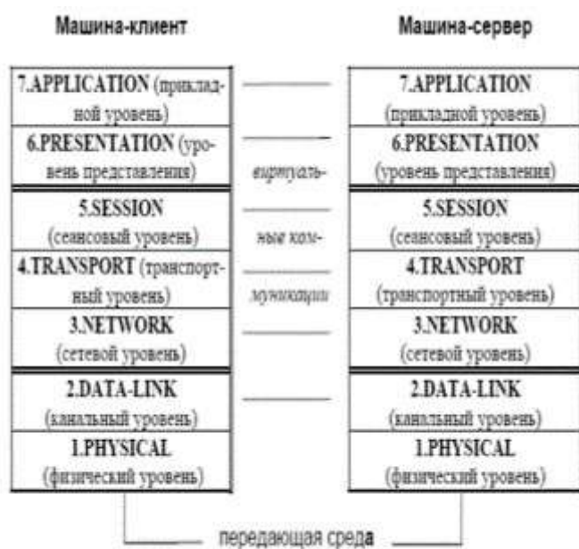
Рис.2.1. Опорная модель OSI.
