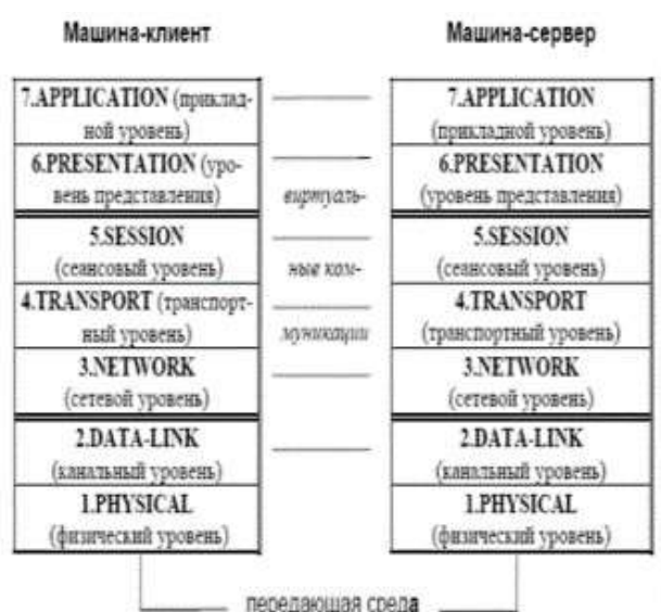
20. Рис.2.1. Опорная модель OSI
