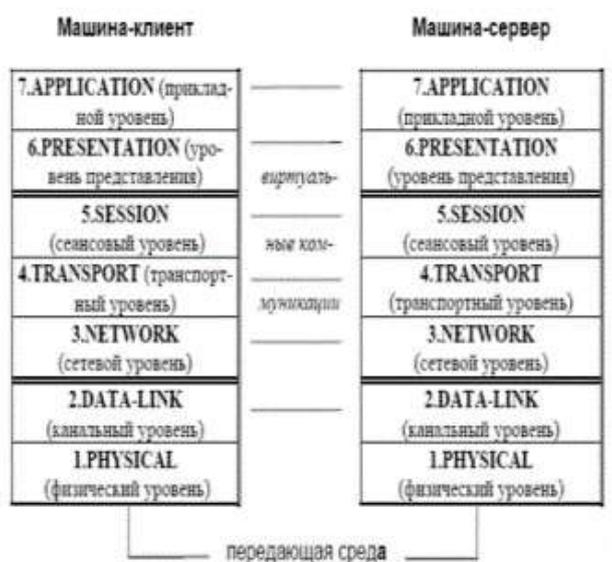
20. Рис.2.1. Опорная модель OSI
